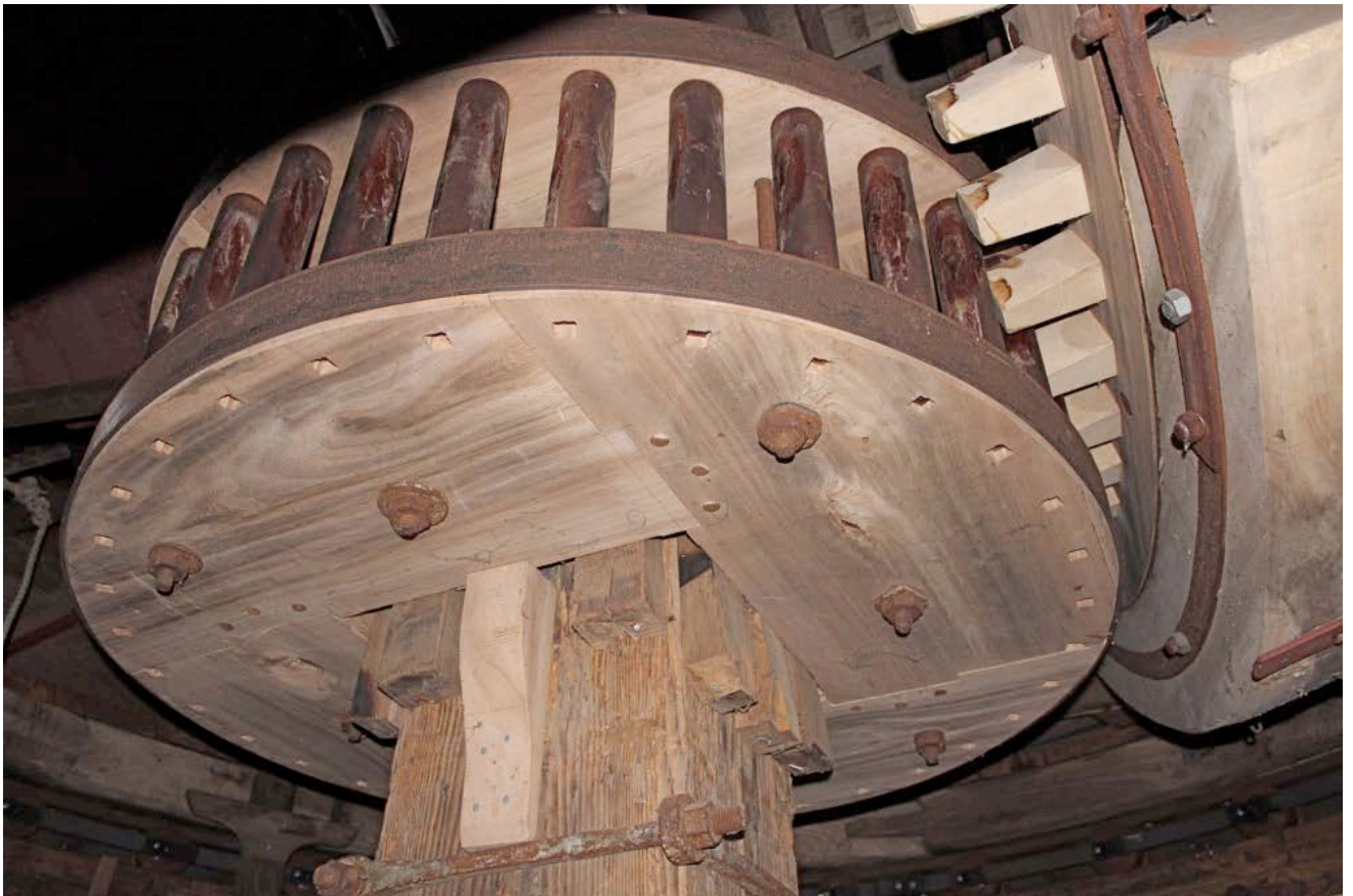
De ingrijping bovenwiel – wieg dient te worden afgeschermd.
